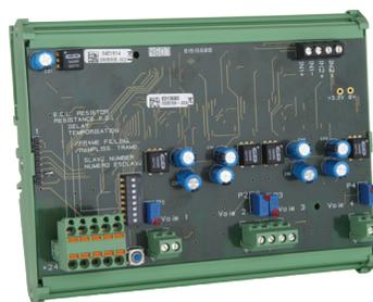
可编址的 4 个模拟量输出模块，可提供 4 组 4-20 mA 模拟量信号输出（检测仪的输出值、最小值、最大值、平均值）以连接至数据记录仪、PLC、楼宇管理系统 (BMS) 等。
